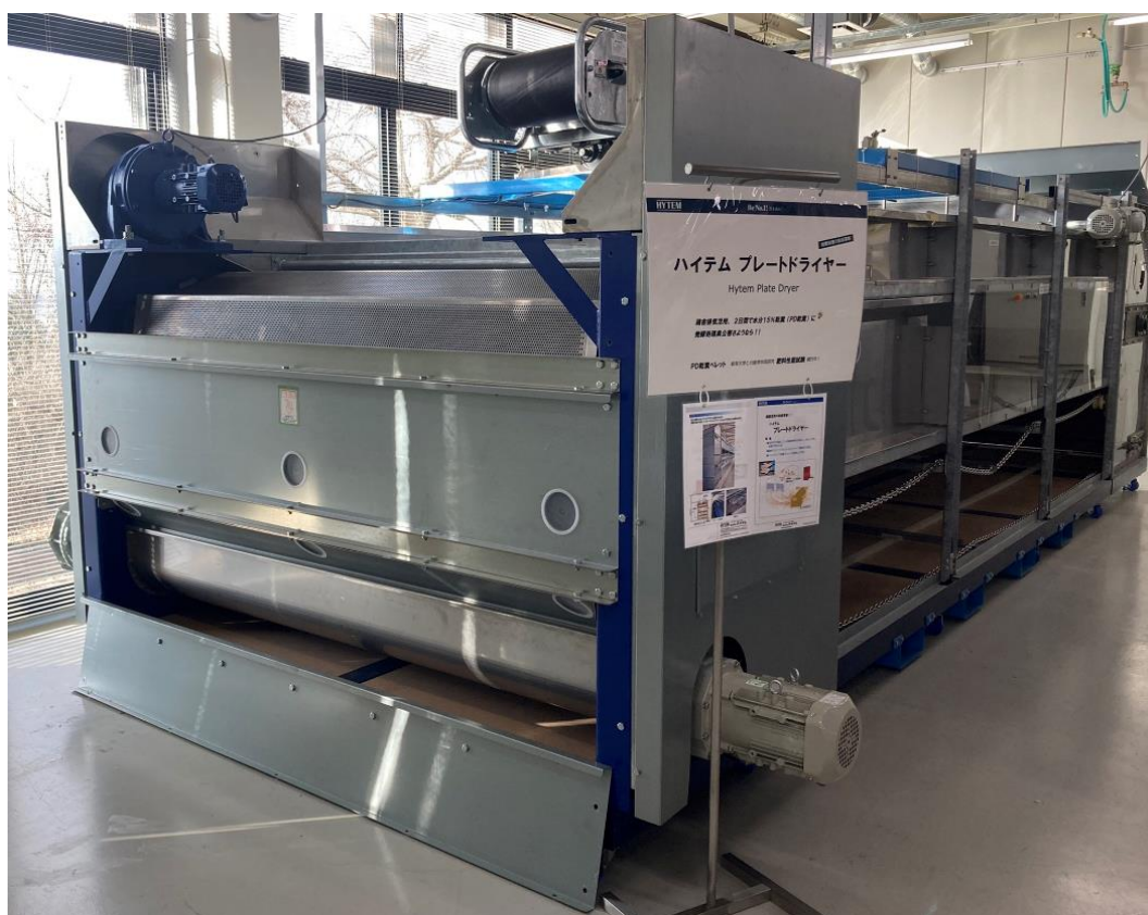
ハイテム本社 稼働展示センターのプレートドライヤー
